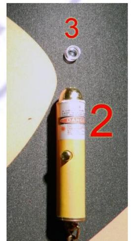
Y una vez que hemos obtenido la lente, la colocaremos delante de la cámara del móvil, fijándola con un poco de celo o papel film, de tal manera que quede completamente transparente y no interfiera en la calidad de visión.
